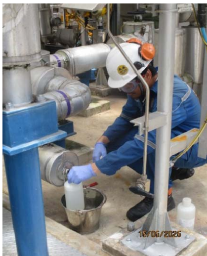
น้ำที่หมุนเวียนในระบบดักจับไอระเหยฟีนอลด้วยน้ำ ในระบบ Phenol Scrubber Stack D-1903
